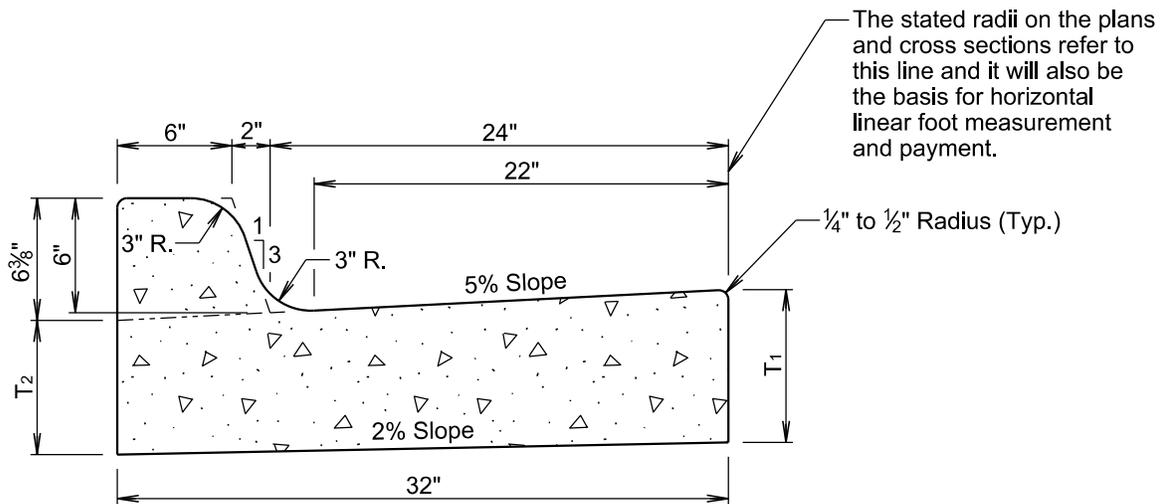
**TYPE B CONCRETE CURB AND GUTTER**
